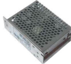
900437 FONTE 60W IN 100-240V | OUT 12V 5A DIMENSÕES: 11X7,9X3,5cm
