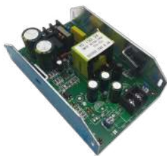
900173 FONTE 150W IN 100-240V | OUT 24V 6,3A DIMENSÕES: 12,7X8,1X3,8cm
